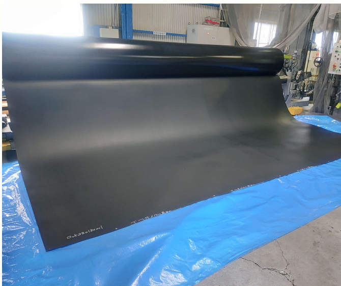
製造した遮水シート
